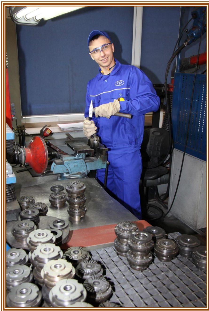
Stanowisko do regeneracji form w zakładzie POL-AM-PACK S.A. - Oddział Huta Szkła „Orzesze”, 2013 rok
