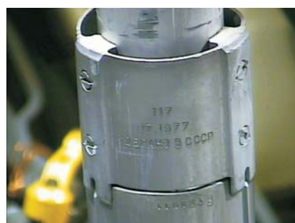
Zestaw paliwowy wkładany do kapsuły
