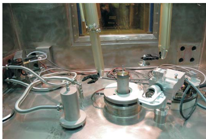
Wnętrze komory do kapsulowania paliwa
