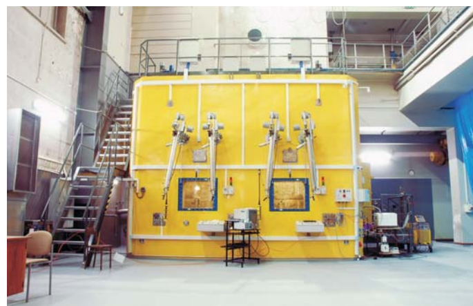
Komory do kapsulowania paliwa, znajdujące się w hali wyłączonej z eksploatacji reaktora EWA w Świerku, widok z zewnątrz
