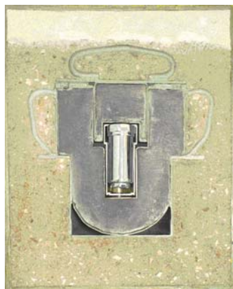
Pojemnik na zużyte igły radowe. Igły wkłada się do pojemniczka stalowego, który jest otoczony grubą warstwą ołowiu, ta zaś betonem i (od góry) ziemią krzemkową. Grubość stali pojemnika wynosi 5 mm.
