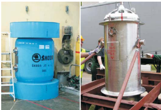
Pojemniki transportowe na wypalone paliwo, wykorzystane do wywozu wypalonego paliwa z reaktorów EWA i MARIA
